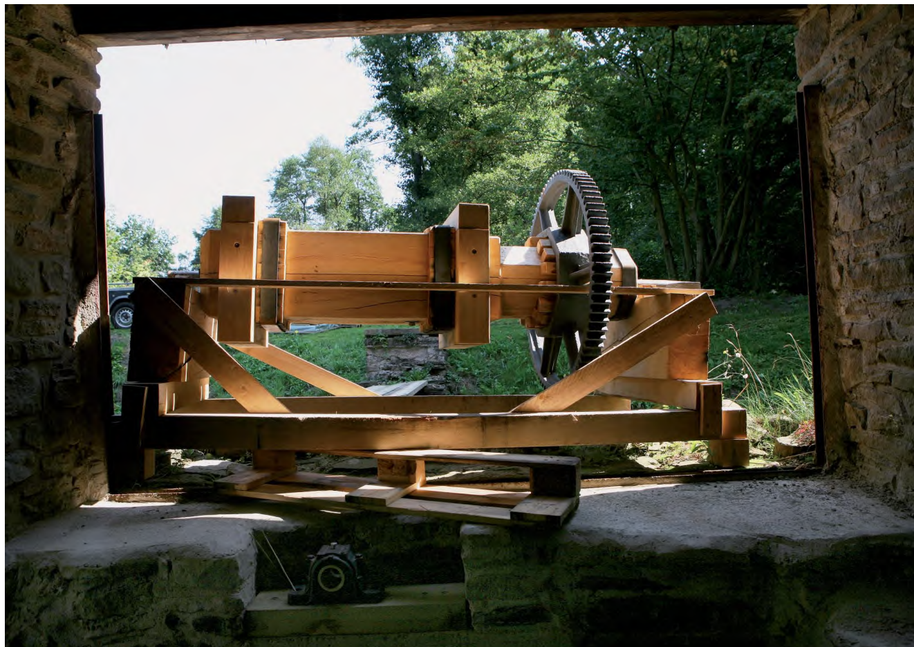
Die Achse der Luftwelle mit Zahnrad vor dem Einbau, 2019 © Rainer Rothenberg/Ruhr Museum
