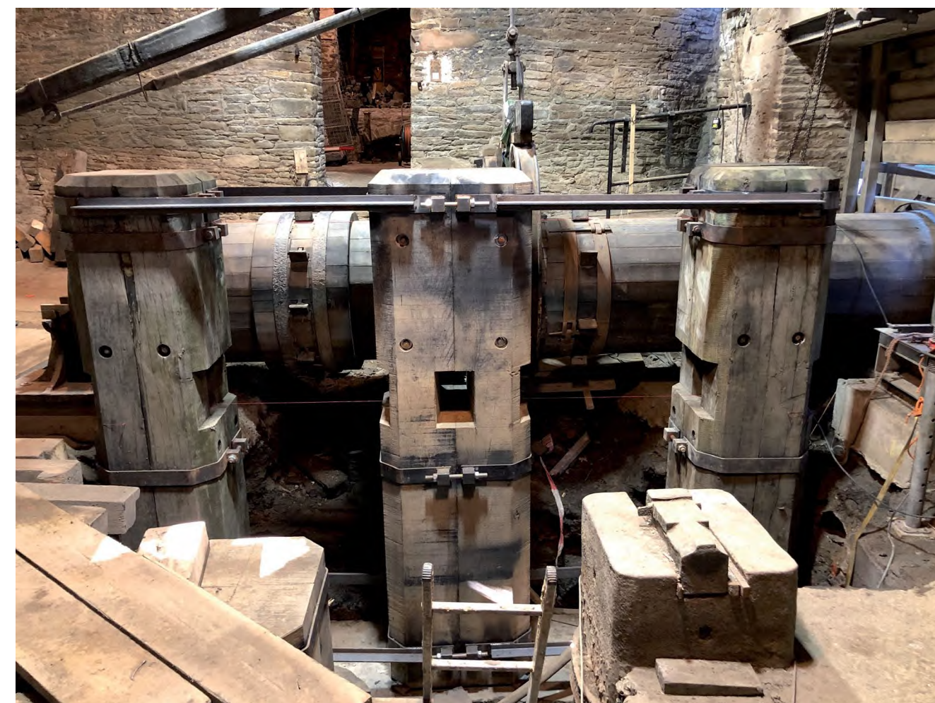
Das neue Hammergerüst nach Fertigstellung, noch ohne Prellhölzer, 2022 © Achim Mikuscheit/Ruhr Museum
