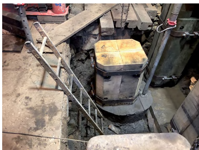
Neuer Eichenholzaufsatz in Verbundtechnik auf alter Schabotte aus den 1930er Jahren, die noch als ganzer Baumstamm ausgebildet war, 2022 © Achim Mikuscheit/Ruhr Museum
