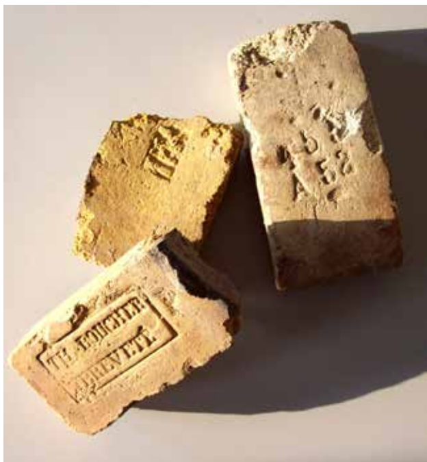
Schamotteziegel mit Beschriftung aus den Ofenkammern (Foto: Peter Hadasch)
